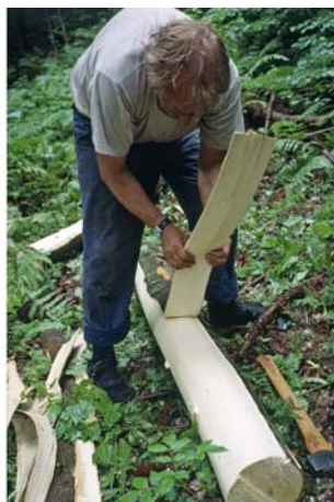
Reblægger Ole Magnus trækker bark af lindegrene til Skuldelev 2 rekonstruktionens lindebast rig. Foto: Werner Karrasch
