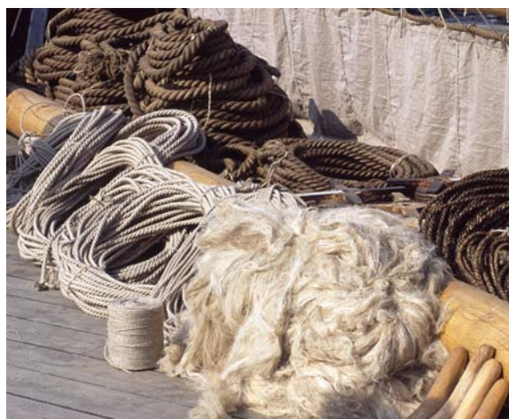
Havhingsten fra Glendaloughs pilotrig er fremstillet af tjæret og utjæret hampetov og et hørsejl på 112 kvadratmeter.
