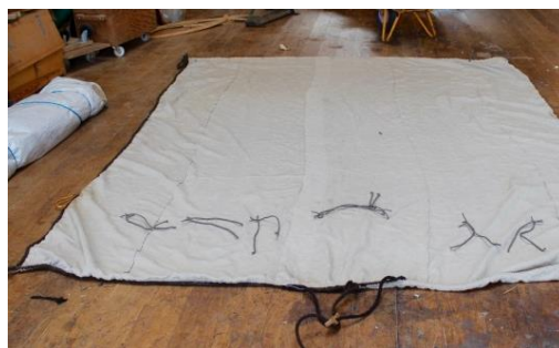
Gislinge III's hørsejl, vævet på en vikingetids opstadvæv, med håndslået hestehårsligtov. Foto: Triona Sørensen.
