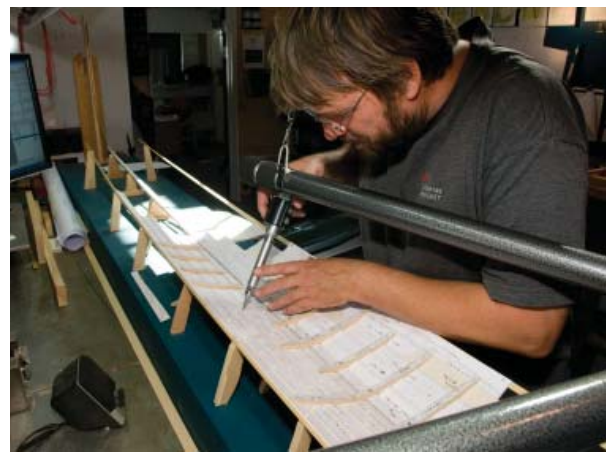
Bådebygger Tom Nicolajsen anvender den elektroniske "FaroArm" til opmåling af 1:10 modellen af Roskilde 6.
