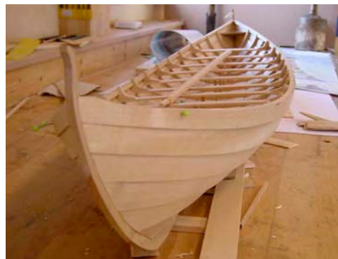
Begge: Bådebygger Hanus Jensens bygge-model i 1:10, som forslag til den næsten 13 m lange Teinæring fra Mykines.
