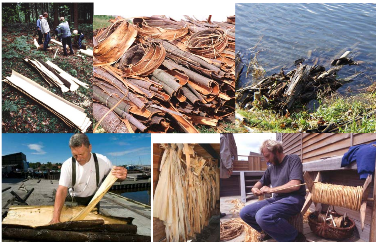
Figur 5: De forskellige arbejdsprocesser i fremstillingen af lindebasttov. Fotos: Werner Karrasch, Vikingeskibsmuseet i Roskilde.
