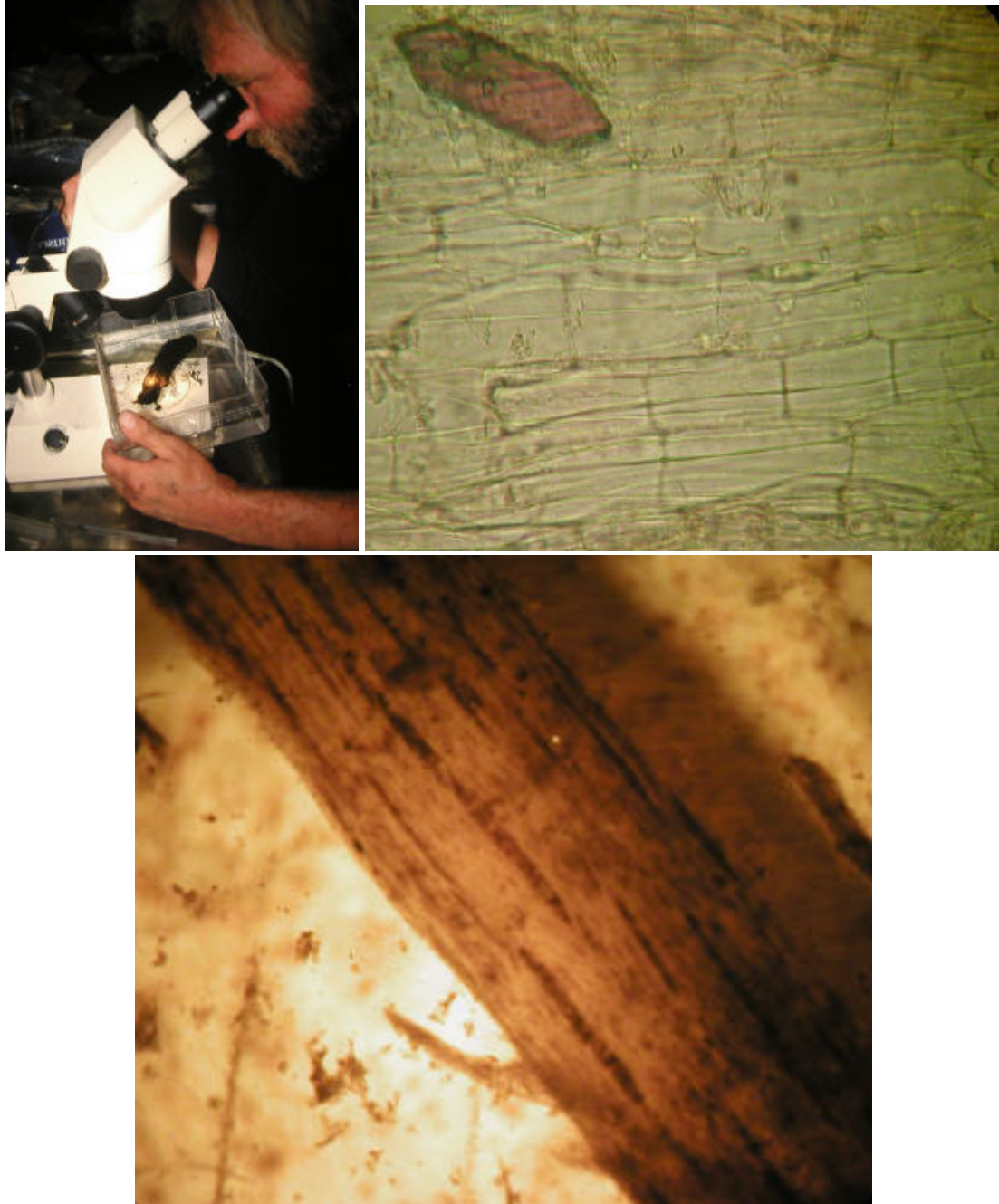
Figur 6: Tovværk fremstillet af lindebast undersøges med mikroskopi. Foto: Vikingeskibsmuseet i Roskilde.
