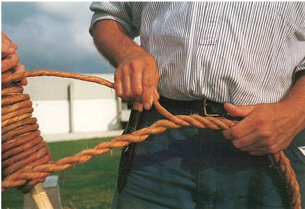
Figur 4: Manuel sammenlægning af lindebasttov. Foto: Werner Karrasch, Vikingeskibsmuseet i Roskilde.
