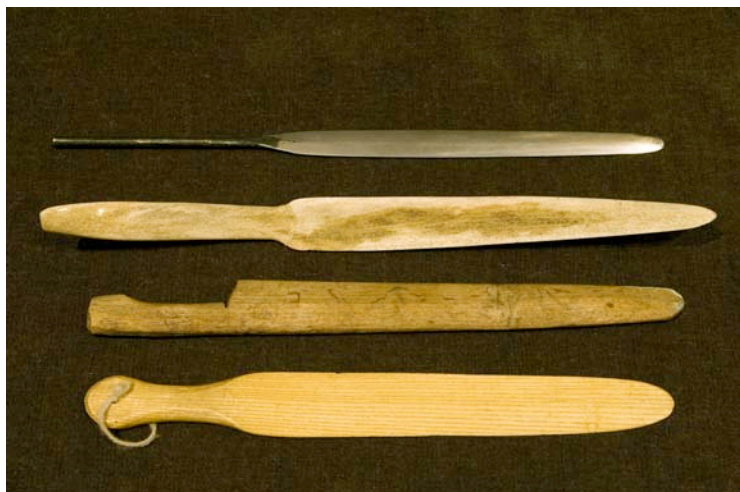
Figur 9: Eksempler på fire forskellige vævesværd brugt af væveren ved vævning af div. stoffer. Øverst ses det til vævning af sejl foretrukne jernsværd (vægt 390 g). Derefter ses et vævesværd af hvalben (vægt 384 g), et gammelt svensk vævesværd af egetræ (vægt 179 g) og et nyt træsværd af asketræ fremstillet til dragtstof (vægt 199 g). (foto: Werner Karrasch, Vikingskibsmuseet i Roskilde)
