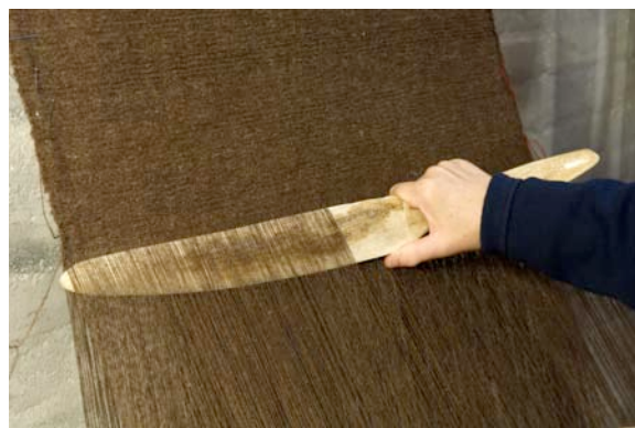
Figur 11: Vævesværdet af hvalben i brug. Bemærk hvorledes den lette bue på sværdet gør, at hånden og skaftet kommer fri af vævningen og trendtrådene. (foto: Werner Karrasch, Vikingskibsmuseet i Roskilde)
