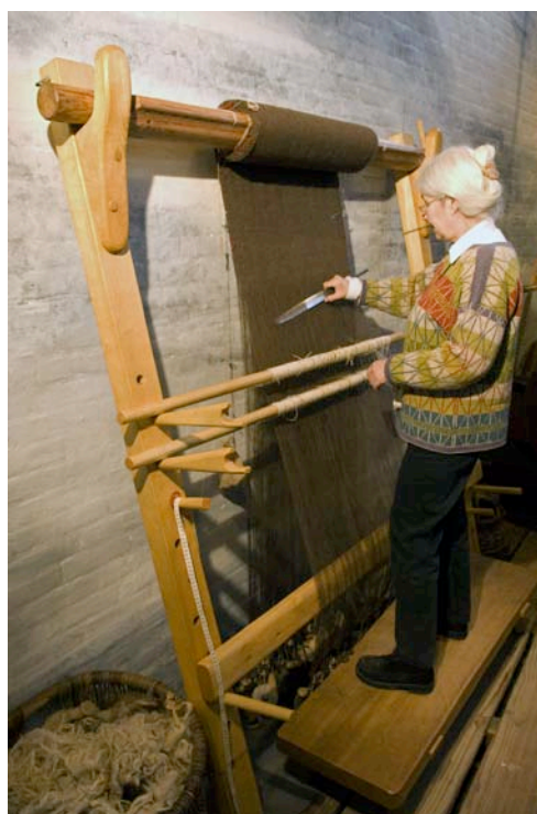
Figur 6: Når der væves højt på væven, bliver skafteholderne anbragt højt og væveren benytter en bänk for at forbedre arbejdsstillingen. Som vævningen skrider frem flyttes skafteholderne længere ned og bænken fjernes. (foto: Werner Karrasch, Vikingeskibsmuseet i Roskilde)
