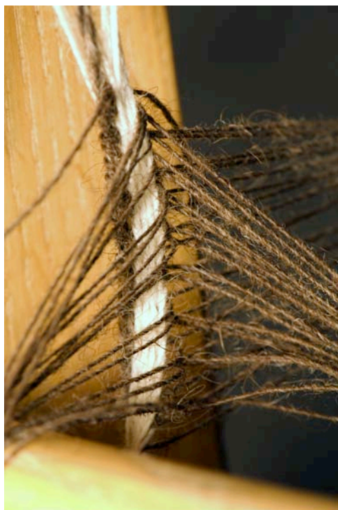
Figur 19: Allerede ved fremstillingen af trenden blev trendtrådene delt i de tre lag, der skal bruges ved vævning af treskaft kiper (2/1 kiper). (foto: Werner Karrasch, Vikingeskibsmuseet i Roskilde)
