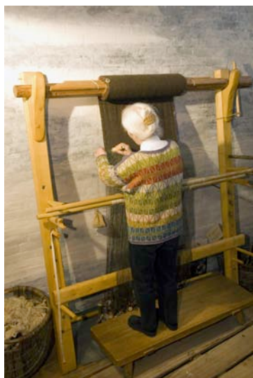
Figur 32: Under væverens venstre arm ses en lille pose fyldt med sten og ophængt i en snor rundt om stofbommen ved ægkanten af det vævede stof. Denne anordning virker som en lodsnor og hjælper væveren med at holde en lige ægkant. (foto: Werner Karrasch, Vikingskibsmuseet i Roskilde)
