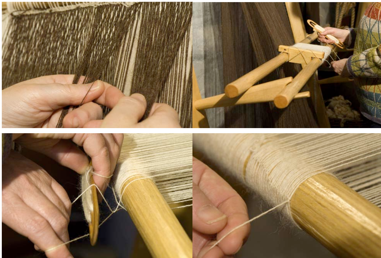
Figur 29: Øverst til venstre: Trendtråden der skal ligge i søllen. Øverst til højre: For at søllerne skal få samme længde bindes de rundt om et ekstra sølskaft, der fjernes når alle søller til et skaft er bundet. Afstanden mellem de to stokke holdes ved hjælp af en træklods på hver side. Nederst til venstre: Hver sølle bliver låst fast med en ekstra knude, der efter bindingen strammes til. Nederst til højre: Mellem hver sølle lægges en ekstra tråd rundt om sølskaftet for at danne afstand mellem søllerne. (foto: Werner Karrasch, Vikingeskibsmuseet i Roskilde)
