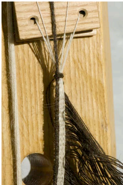
Figur 21: Under fremstilling af trenden bliver trendtrådene fastgjort ved hjælp af et brikvævet bånd. (foto: Werner Karrasch, Vikingeskibsmuseet i Roskilde)
