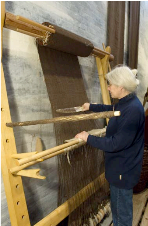
Figur 16: Mens islættet bankes sammen og skytten ikke er i brug, anbringes skytten i et af de tomme huller i sidestolperne. (foto: Werner Karrasch, Vikingeskibsmuseet i Roskilde)
