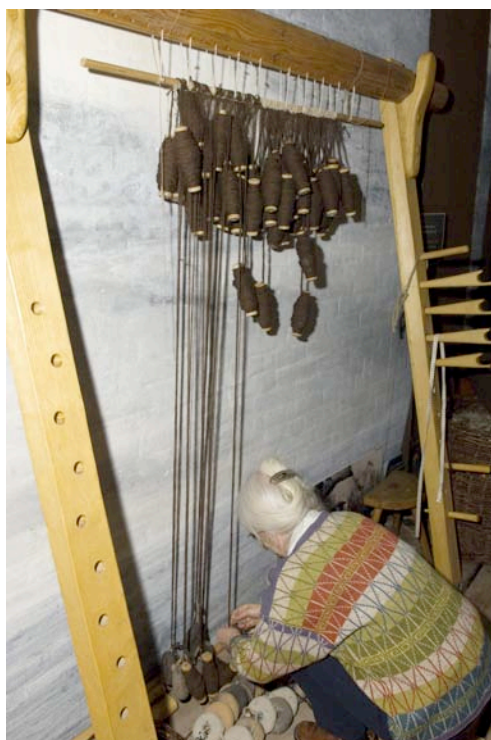
Figur 26: Vænevægtene fastgøres først til det bagerste lag trendtråde. (foto: Werner Karrasch, Vikingskibsmuseet i Roskilde)
