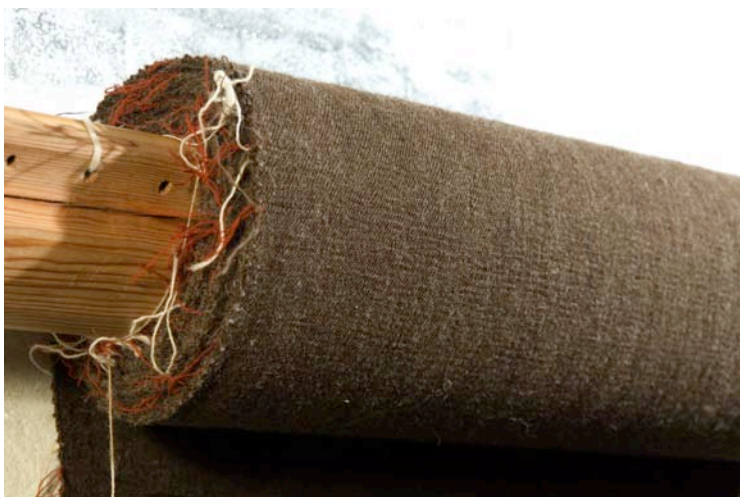
Figur 35: Stofbommen med 6 meter vævet sejldug, der har medført at omkredsen på stofbommen er blevet dobbelt så stor. Trendtrådene er derfor blevet presset 5 cm længere bagud. (foto: Werner Karrasch, Vikingeskibsmuseet i Roskilde)
