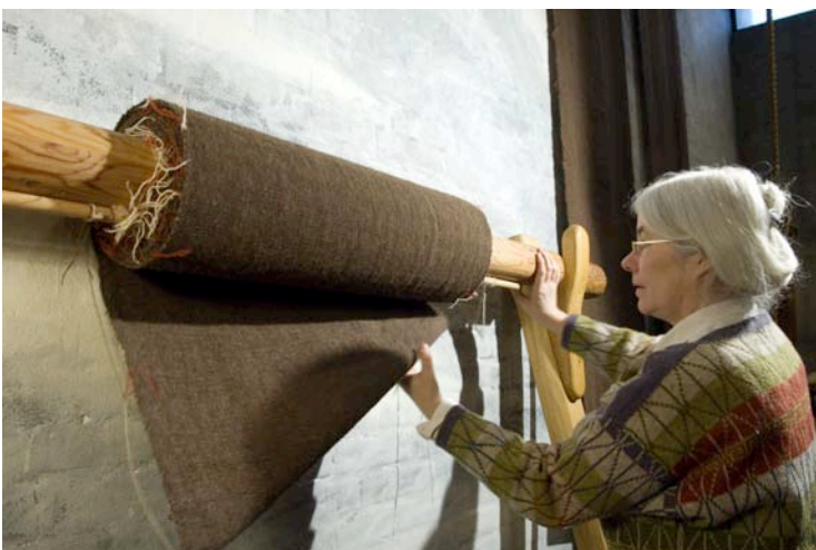
Figur 4: Stofbommen med to færdigvævede baner til sejlet. (foto: Werner Karrasch, Vikingeskibsmuseet i Roskilde).
