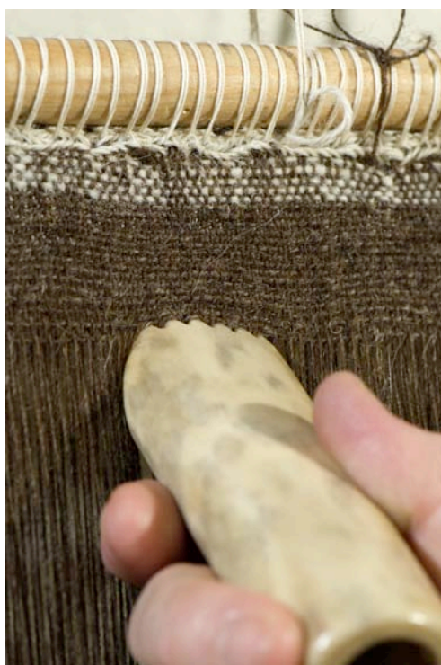
Figur 12: Ved hjælp af vævekammen kan islætstrådene presses ekstra tæt sammen, hvilket er vigtigt for en sejldug. Bemærk at kammen vippes mod højre idet væveren er højrehåndet. Håndværkerens arbejdsmetoder sætter sine spor. (foto: Werner Karrasch, Vikingskibsmuseet i Roskilde)
