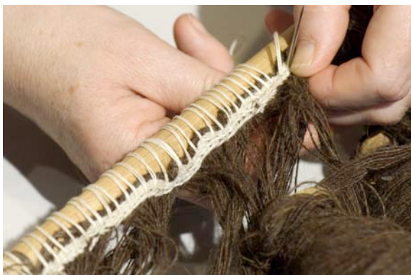
Figur 24: Trenden og det brikvævede bånd sys fast på den tynde pind, således at der kommer 27 tråde pr. 2 cm. (foto: Werner Karrasch, Vikingeskibsmuseet i Roskilde)
