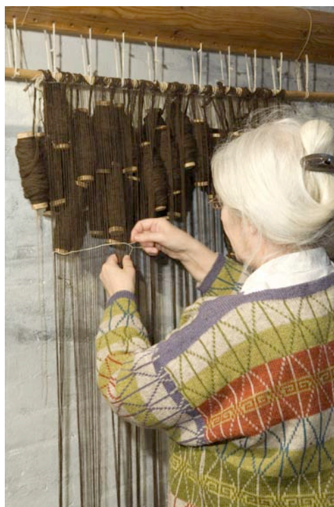
Figur 27: Styresnoren hækles med to trendtråde i hver løkke. For at få trendtrådene til at ligge i den rigtige rækkefølge er der nemmest at hække styresnoren tæt på opsætningsbåndet. (foto: Werner Karrasch, Vikingskibsmuseet i Roskilde)
