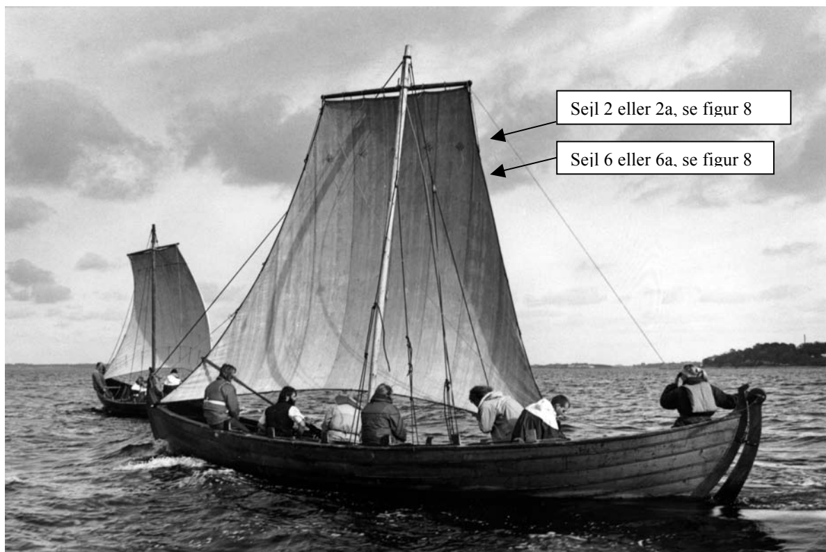
Fig. 9. Vikingskibsmuseets færøske seksæring Embla under skarp bidévindsejlsads på Roskilde Fjord med sit uldsejl (se bilag 1). Embla er med bedre højde og fart i færd med at skære op forbi seksæringen Ask , der har en tilsvarende sejlstørrelse i bomuld. Begge sejl er i højden udmålt efter den islandske 'rammeregel'. Ved Emblas sejl markerer to pile sejlhøjder udmålt efter Svabo.
