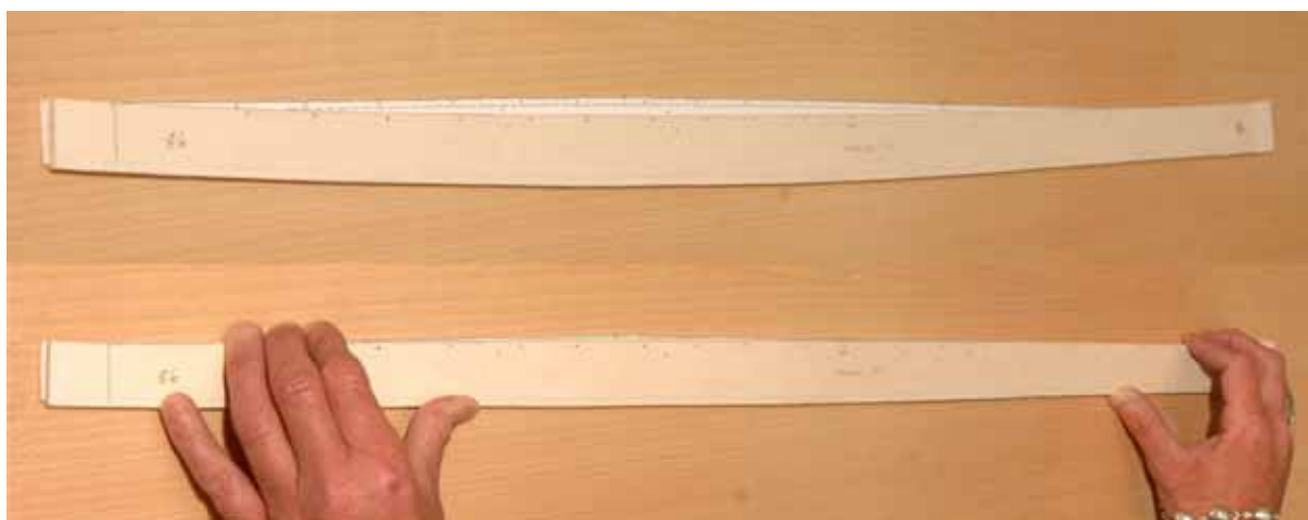
Fig. 4.21. Modelbordenes form blev ændret langskibs i 11. og 12. bordgang, så de passede til undervandsskrogets rekonstruerede skrogform. Deres formændring blev kontrolleret ved en sammenligning med skabelonerne af bordene fra det udstillede skib. Foto Werner Karrasch, Vikingeskibsmuseet i Roskilde.
