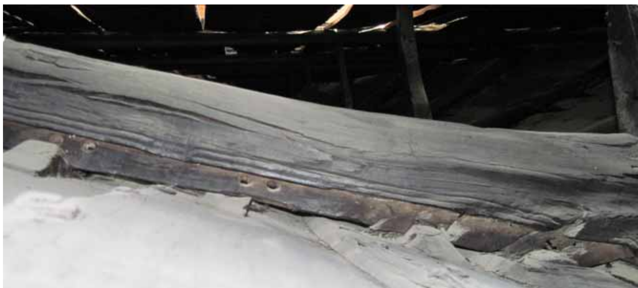
Fig. 6.15. Den underste del af bundstokken og den øverste del af klampen er kollapsede i det udstillede skib, så bordet og bundstokken står tættere sammen, end de oprindeligt har gjort. Det fremgår af fotoet, at bundstokken ikke ville støde mod bordet, hvis klamperne ikke var kollapsede. Dette kollaps er der ikke kompenseret for i hverken Glendes, Johannessens eller Lundins tegninger af skibet. Foto forfatteren.
