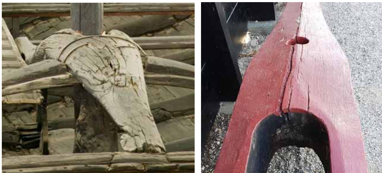
Fig. 6.23. Mastefisken på Osebergskibet er repareret eller forstærket med jernbånd på tværs foran masten foto tv. Havhingsten fra Glendaloughs mastefisk (th.) flækkede på grund af optørring, fordi marven, som på Osebergskibets mastefisk, ligger midt i emnet. Foto th. Kulturhistorisk Museum i Oslo. Foto tv. forfatteren.
