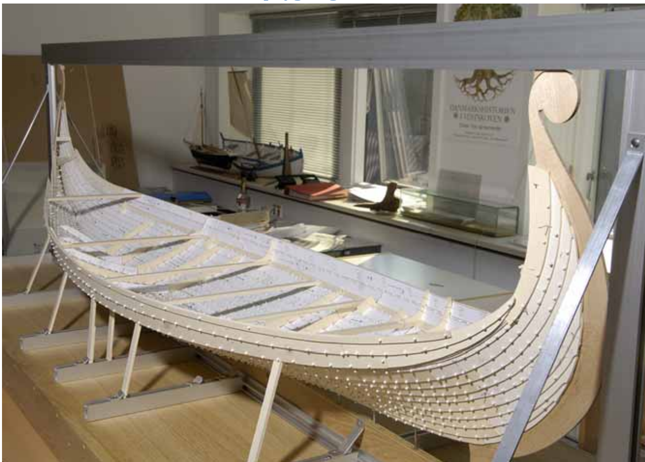
Fig. 4.10. Modellen i skala 1:10 blev bygget med henblik på rekonstruktion af skibets skrogform, som forarbejde til en forestående bygning af skibet i fuld størrelse.
