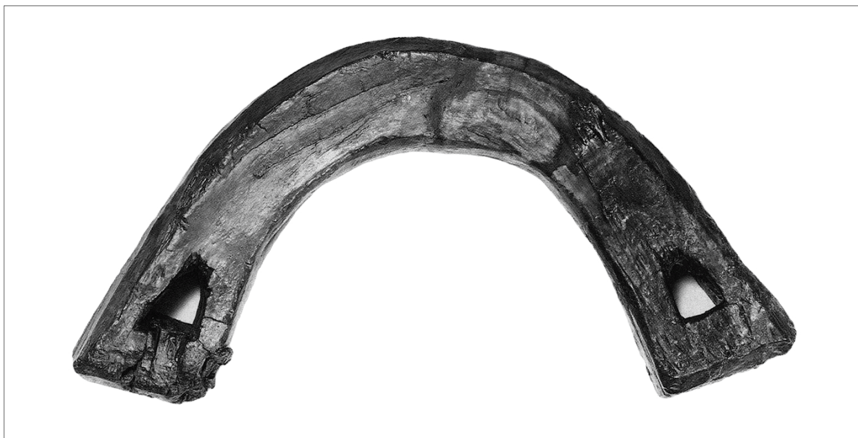
Fig. 8. 8. Rakken holdt råen med sejlet ind til masten. Den blev fundet bundet omkring et rundholt i forskibet med tovværk på 25 mm tykkelse. Foto Kulturhistorisk Museum Oslo. Efter Christensen et al. 2006.
