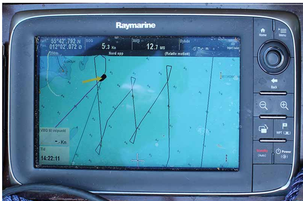
Fig. 10.22. Kryds med kovendinger på Yderbredningen i Roskilde Fjord i 12-14 m/s. Som det ses på billedet, kovender Saga Oseberg med en lille venderadius, noget der kan tilskrives skibets buede køl. Skibet krydsede 65° til vinden inklusiv afdrift, med et reb i sejlet. Foto forfatteren.
