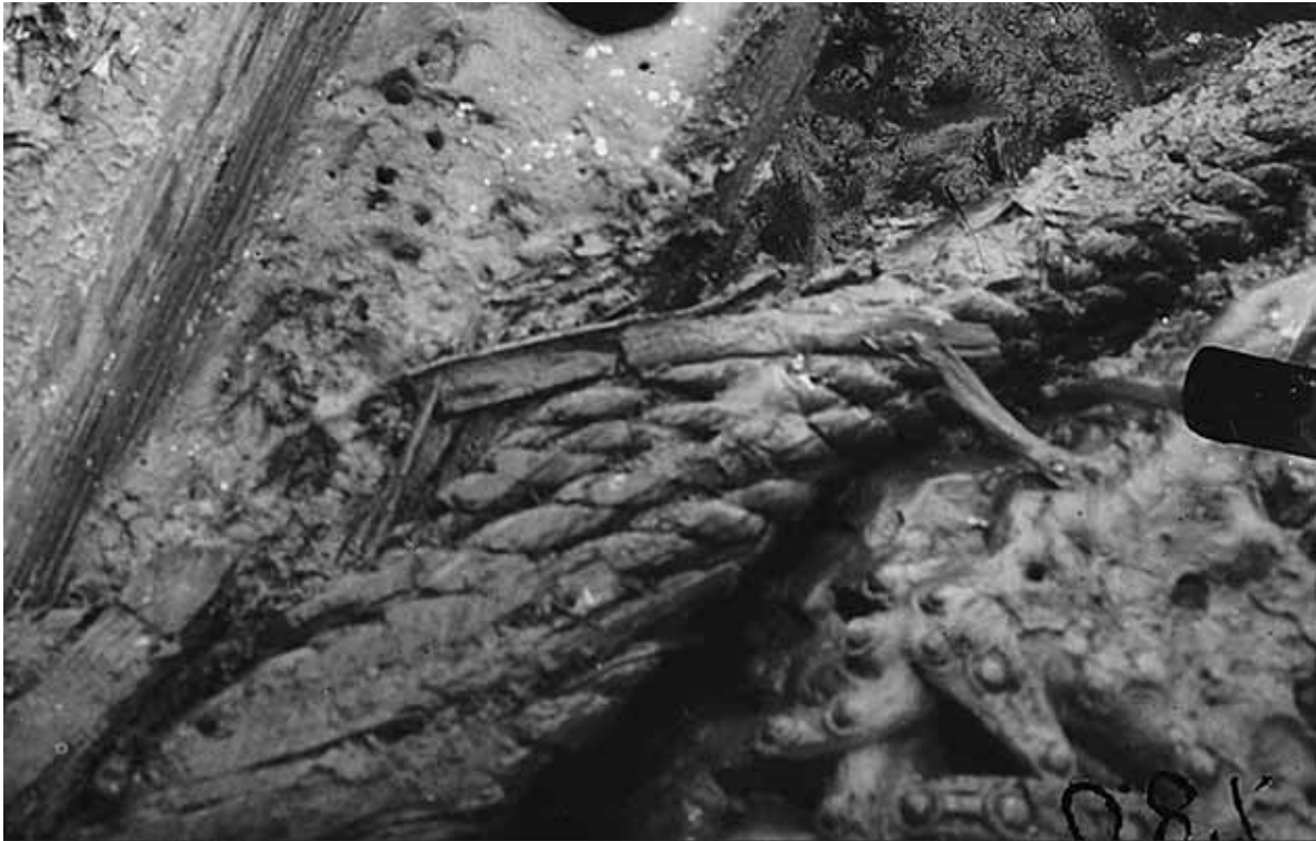
Fig. 8.14. En kraftig kabellagt trosse i Osebergskibet. Undertegnede bedømmer den til at være minimum 6,0 cm i diameter. Foto Kulturhistorisk Museum i Oslo.
