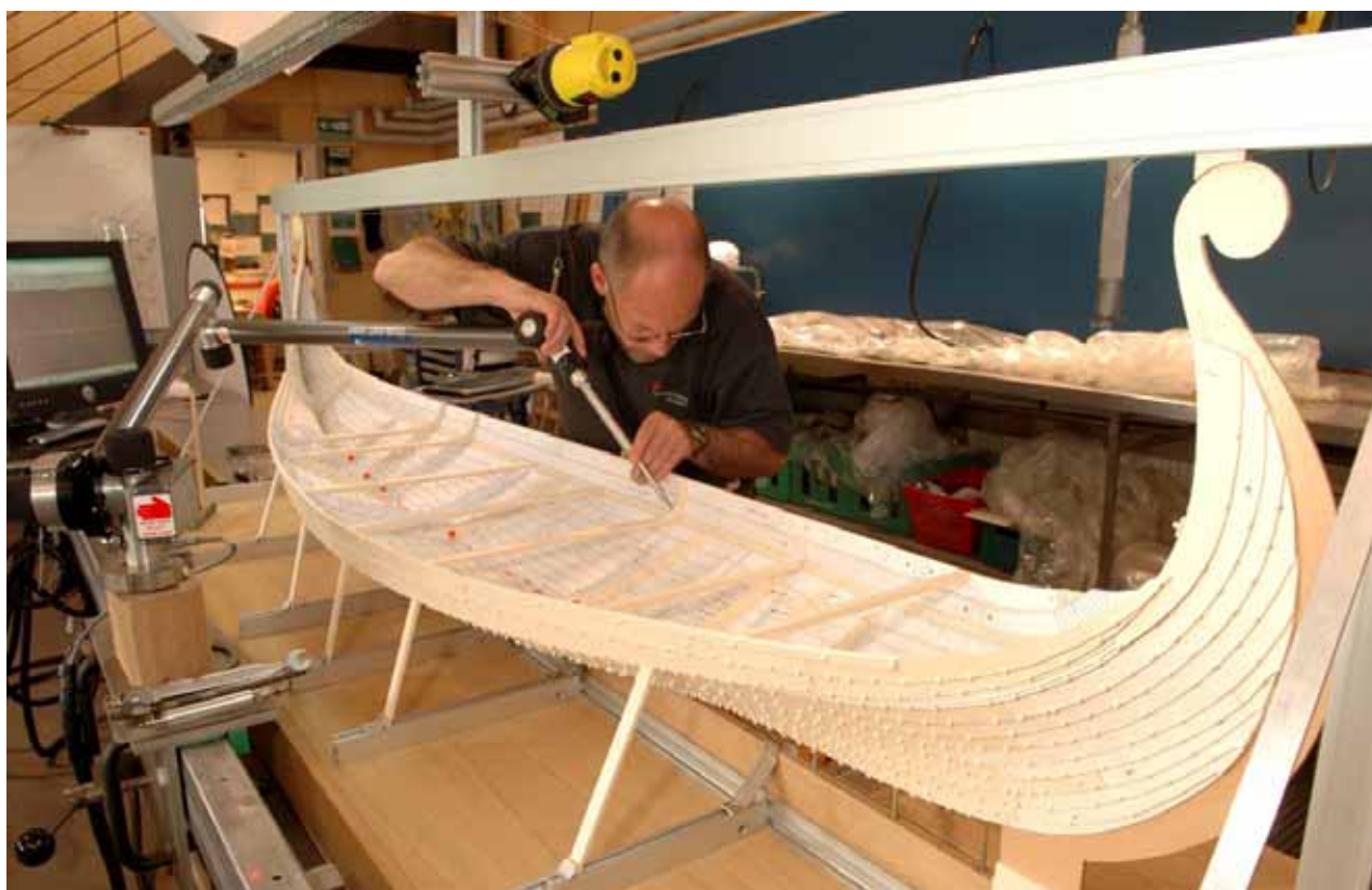
Fig. 4.25. Rekonstruktionsmodellem blev digitalt opmålt med en Faro Arm ® , og modellens dimensioner blev overført direkte til 3D programmet Rhinoceros ® . Foto Werner Karrasch, Vikingskibsmuseet i Roskilde.
