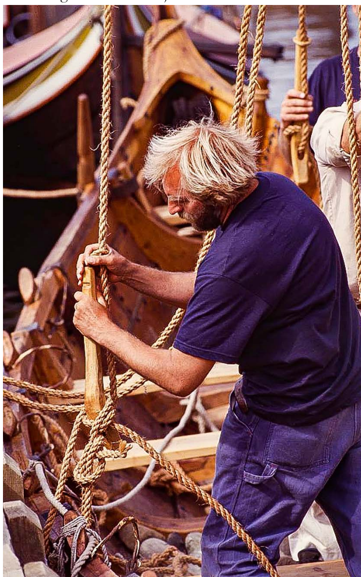
Ole Magnus strammer og fæstner et vant om bord på Kraka Fyr Foto: Werner Karrasch, Vikingeskibsmuseet i Roskilde
