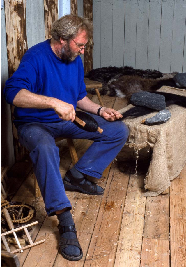
Ole Magnus arbejder med at fremstille tovværk af bestebår. Foto: Werner Karrasch, Vikingskibsmuseet i Roskilde
