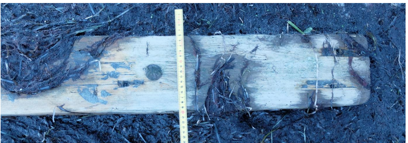
Figur 3. Fyrreplanke med trænegle samt spigerhuller. Foto: Mikkel H. Thomsen © Vikingeskibsmuseet.
