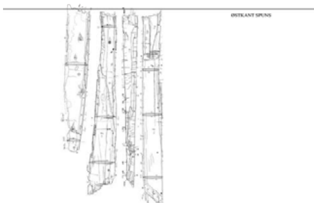
Figur 4 Foreløbig bordudfoldning af Roskilde 5, forstævnen opad. Enkelte fragmenter mangler fortsat. Det agterste parti er placeret ud fra, at kun 1½ spantrum er blevet gravet væk.
