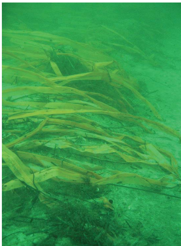
Figur 8: De kunstige ålegræsblade fangede hurtigt sandpartikler.
