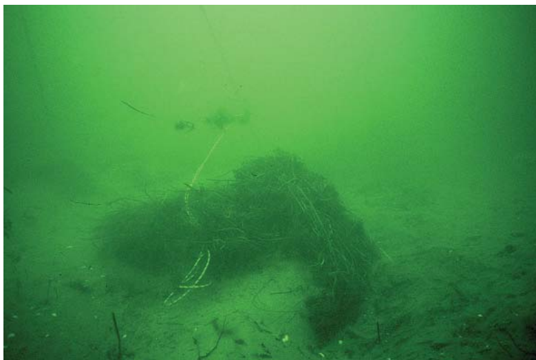
Figur 2: Målesystemet havde fanget ålegræs og medført lokal erosion
