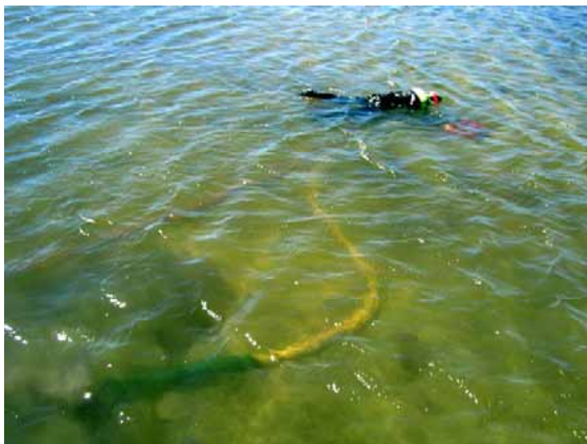
Figur 2: Etablering af prøvehul. Det opsugede materiale opsamles i et finmasket net til senere sortering på overfladen. Foto: Morten Johansen
