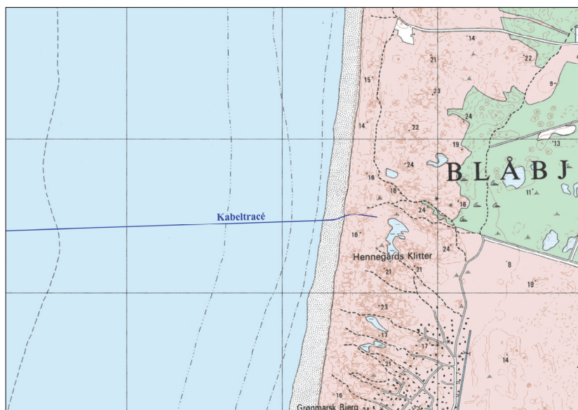
Figur 2: Kabeltracé ved Blåbjerg Plantage.
