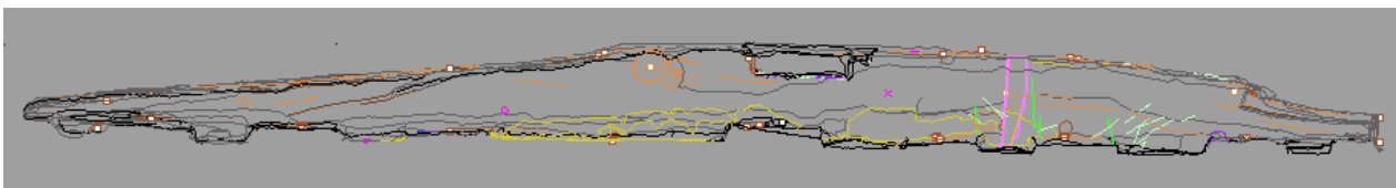
Figur 10: Kølsvin x1, set fra stb. side (1:25). Opmåling: Morten Ravn og Mikkel H. Thomsen. © Vikingskibsmuseet.
