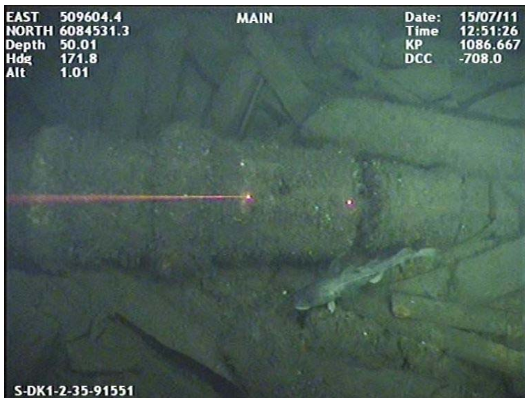
Figur 30: MAJ 2637. Ankerspil; detalje af den ene halvdel.
