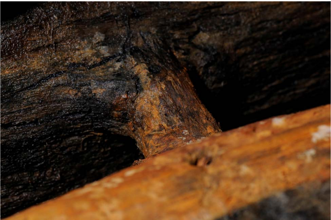
Figur 13: Trænagle synlig mellem rorstamme og opklodsning. Foto: Werner Karrasch © Vikingskibsmuseet.
