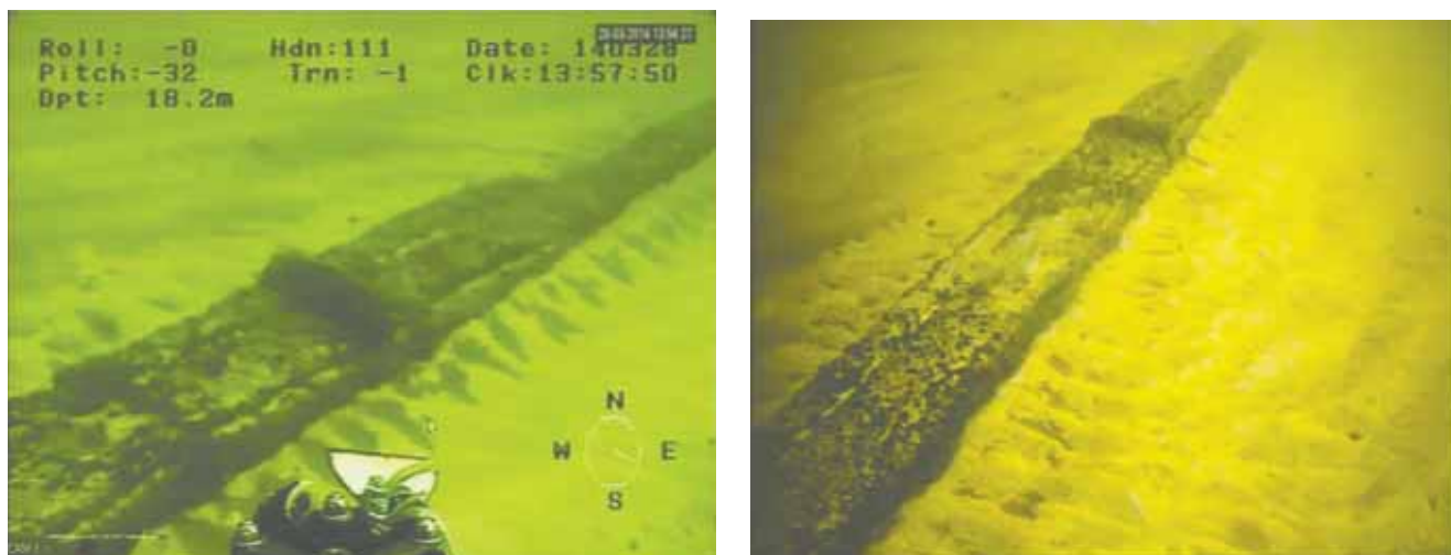
Figur 28: VIR 2763, contact0024, kølsvin af to dele holdt sammen af jernbånd (bullen midt i billedet). ROV-foto samt foto fra dykkervideo.
