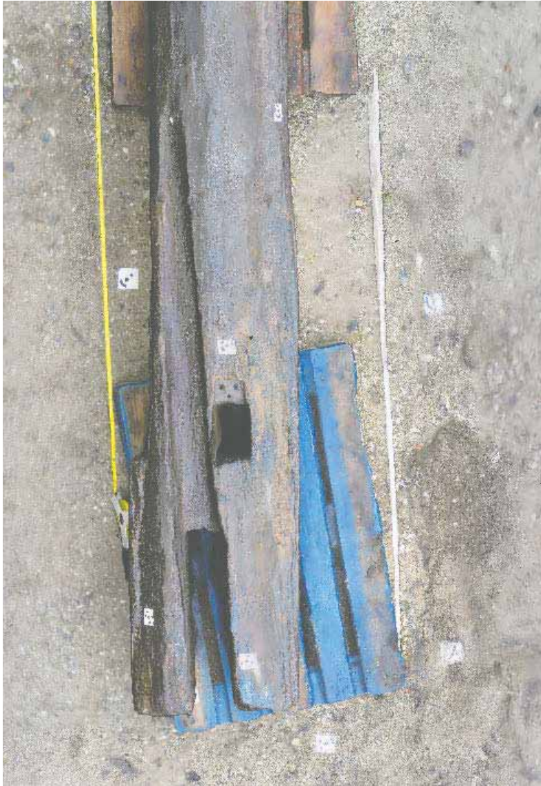
Figur 178: VIR 2759, contact0154, skivgat og rille for stængevindereb samt hul for låseklods i mastens nederste ende. 3D-model: Matko Cvrljak © Vikingeskibsmuseet.
