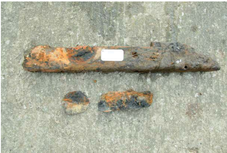
Figur 5. Hageplanke (X1001) med dæklap af bly (aftaget, fra oversiden) og korroderet jernbeslag (fra undersiden). Foto: Mikkel H. Thomsen © Vikingskibsmuseet.
