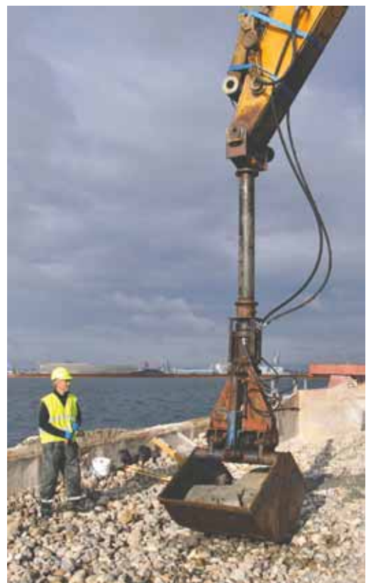
Fig. 3. Gravemaskine med forlængende stik og symmetrisk grab. Foto: Frederik Hyttel, Vikingeskibsmuseet.
