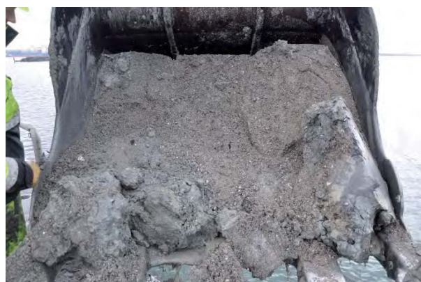
Fig. 2c. Typisk prøve nær den nuværende sejlrende – store klumper af blåler i/over homogent grus. Foto: Frederik D. Hyttel, Vikingeskibsmuseet.
