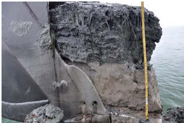
Fig. 2a. Typisk stratigrafi – slam og ålegræs, marmoreret sortgråt/lysgråt sand, lyst gulligt sand med organisk smuld. Foto: Frederik D. Hyttel, Vikingeskibsmuseet.
