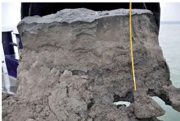
Fig. 2b. Typisk stratigrafi fortsat – lyst gulligt sand med organisk smuld, grushorizont med en smule organisk indhold, og grågrønt groft sand med småsten. Foto: Frederik D. Hyttel, Vikingeskibsmuseet.
