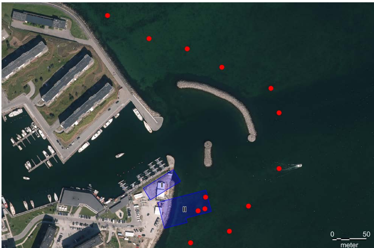
Fig. 3. Tidligere boreprøver i og omkring byggefelt II.
