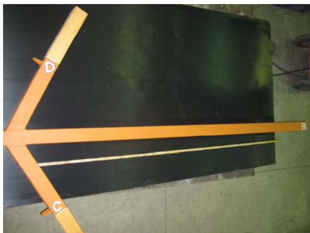
Fig. 3. Ankerformet jernramme til bjærgning med afmærkede (A-D) øjer til løftestropper. (Foto: Nationalmuseet)
