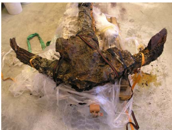
Fig. 3 a og b. Store konglomerater af korrosionsprodukter, muslingeskaller og havbund var aflejret i ankerets overflade.
