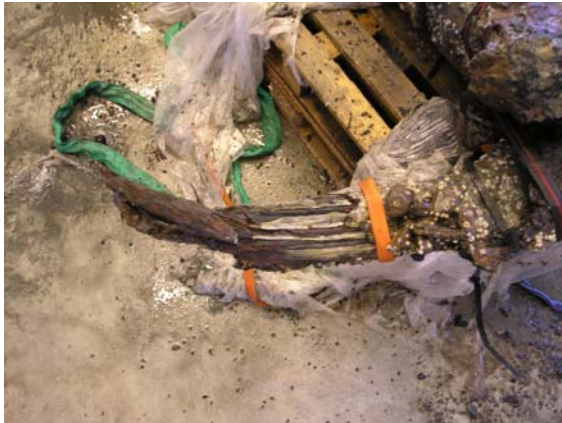
Fig. 4. Ved prøveafrensning af aflejringerne i overfladen fremkom ingen oprindelig genstandsoverflade, blot den nedbrudte jernkerne.
