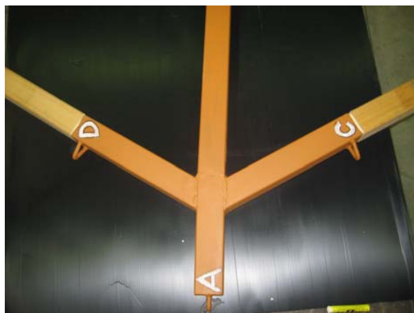
Fig. 1 a og b. Åg til bjærgning med afmærkede (A-D) øjer til løftestropper.
