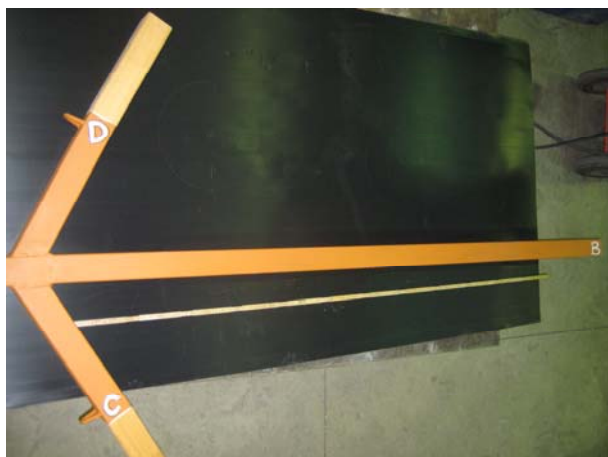
Fig. 1 a og b. Åg til bjærgning med afmærkede (A-D) øjer til løftestropper.
