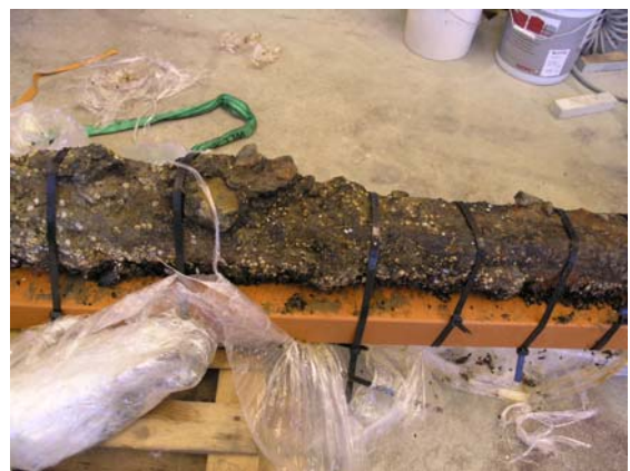
Fig. 3 a og b. Store konglomerater af korrosionsprodukter, muslingeskaller og havbund var aflejret i ankerets overflade.
