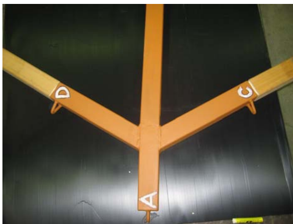
Fig. 3. Ankerformet jernramme til bjærgning med afmærkede (A-D) øjer til løftestropper. (Foto: Nationalmuseet)
