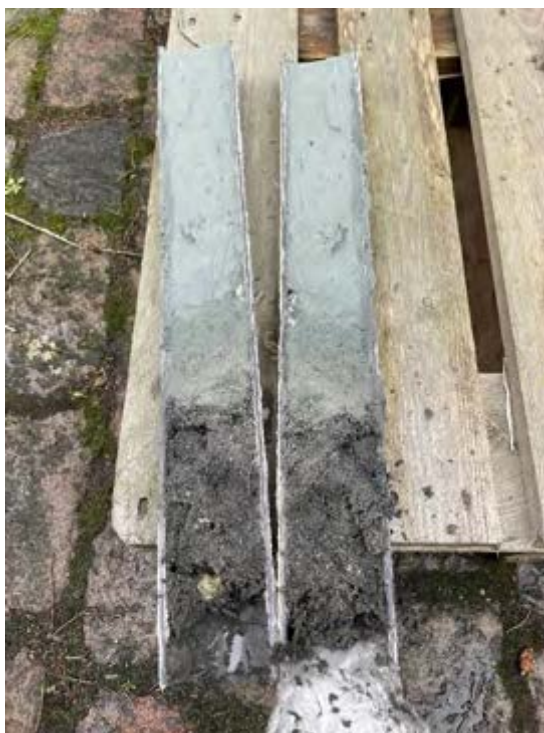
Figur 22. TV: Porevandsprøver udtages med en sprøjte. TH: En borekerne halveres. Foto: Anne Marie Høier Eriksen og Andreas Kallmeyer Bloch
