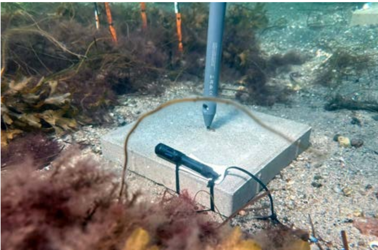
Figur 6. En CTD diver og Tilt Current Meter nedsættes ved de moderne nedsatte prøver.
