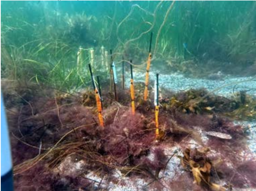
Figur 4. Metalprøverne efter nedsættelse i havbunden. Foto: Kristiane Strækvern.
