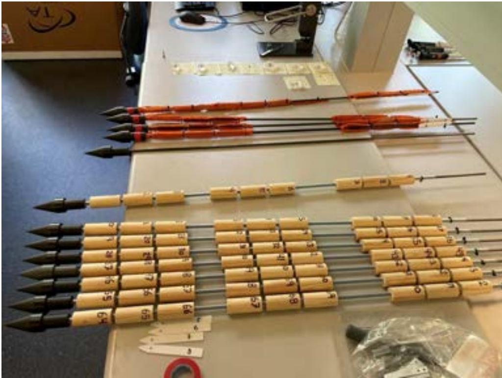
Figur 3. Spyd med moderne træ og metalprøver til nedsættelse. Foto: Anne Marie Høier Eriksen.
