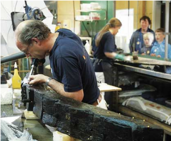
Fig. 3. Opmåling med Faro-Arm benyttet i Standard 2003 og 2008A-C (Foto: Werner Karrasch).
