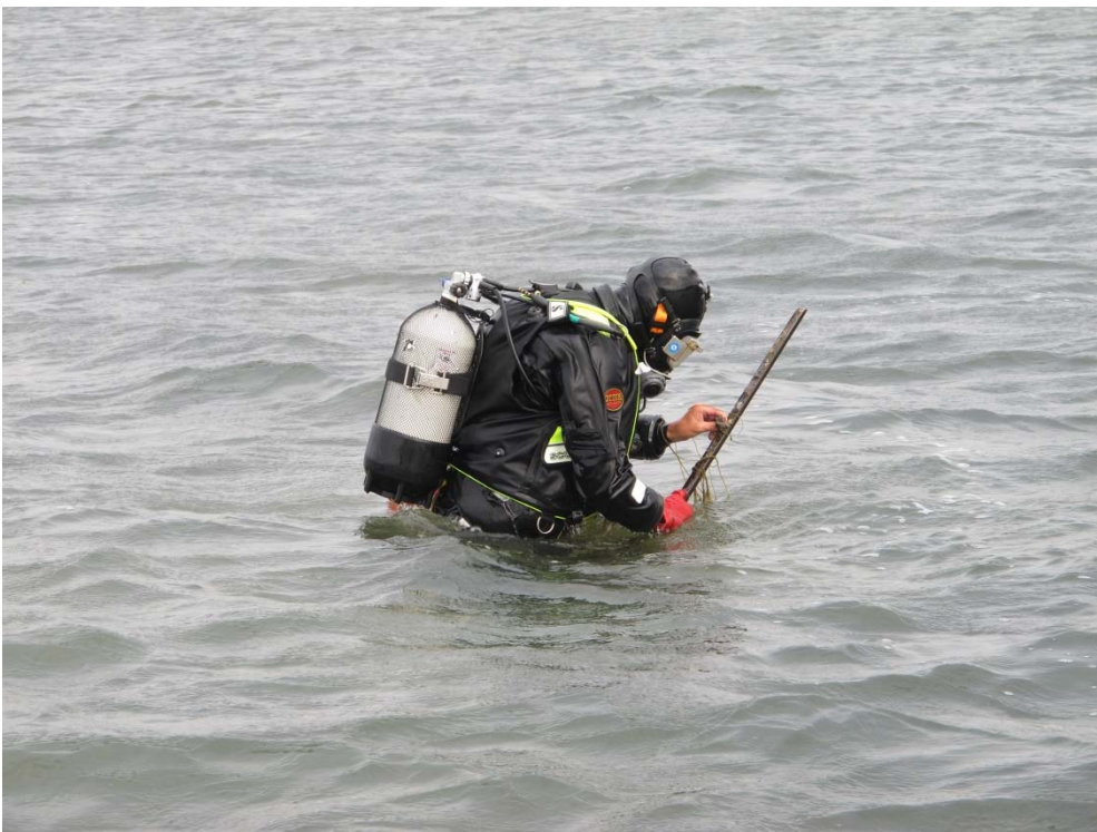
Figur 1. Boreprøver på lavt vand for fastlæggelse af tidligere kystlinie.
