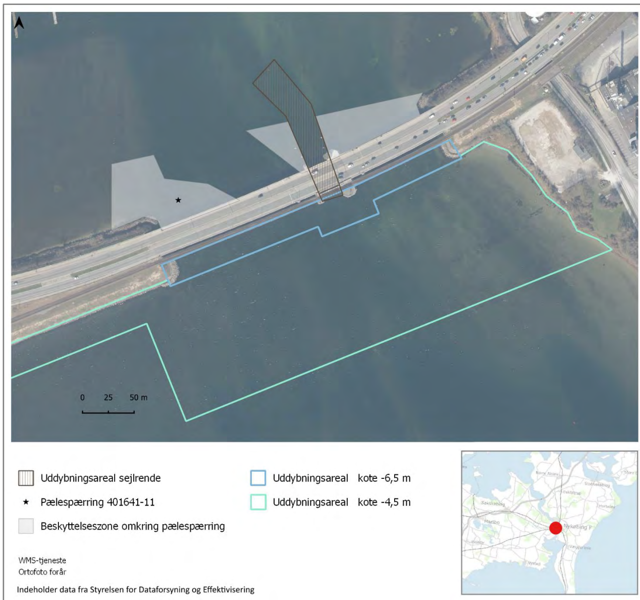
Figur 1: Områder berørt af anlægsarbejdet; omtrentlig placering af pælespærring 401641-11 samt beskyttelseszone omkring pælespærring. Kort: Lea M. H. Jacobsen © Vikingskibsmuseet 2022
